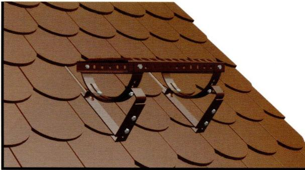
Konzoly typ S alebo SD sú univerzálné držiaky, ktoré sa hodia na väčšinu modelov betónových aj keramických škridiel. V prípade škridľy bobrovky je vhodnou konzolou typ S. Konzola SD je dedikovaná pre korunový vzor. V oboch prípadoch by mala byť rozteč lát v bode pripojenia strešnej komunikácie cca 16 cm.
