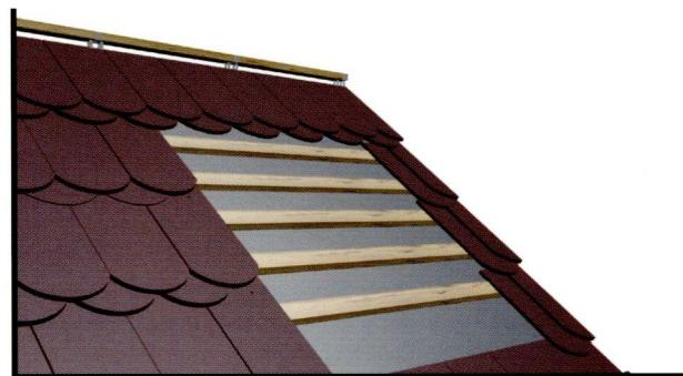
V prípade striech pokrytých bobrovkou ukladanou na korunkové krytie, priskrutkujeme dodatočne montážne laty (v polovici vzdialosti medzi latami, na ktoré sa ukladá škridla).
